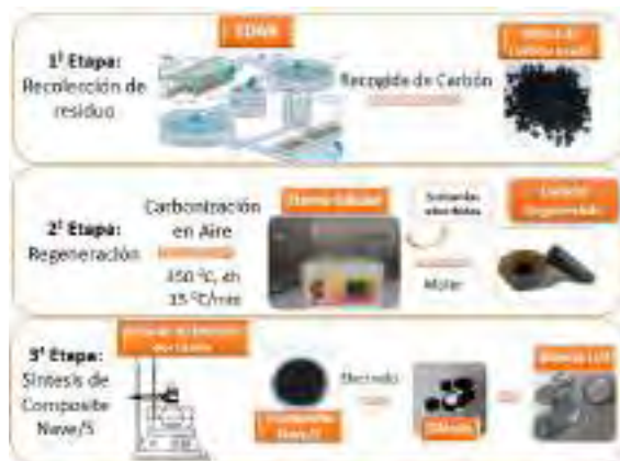
Figura 1. Tratamiento de filtros de carbón de EDAR y síntesis de composite Figura 2. ATG de carbones sin regenerar y composite
