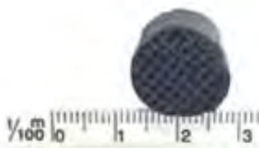
Figura 1. Imagen de un monolito honeycomb integral de carbón mineral preparado.
