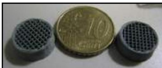
Figure 1. Monolitos Fe/ $\beta$ -SiC sinterizados a 1200 °C.
