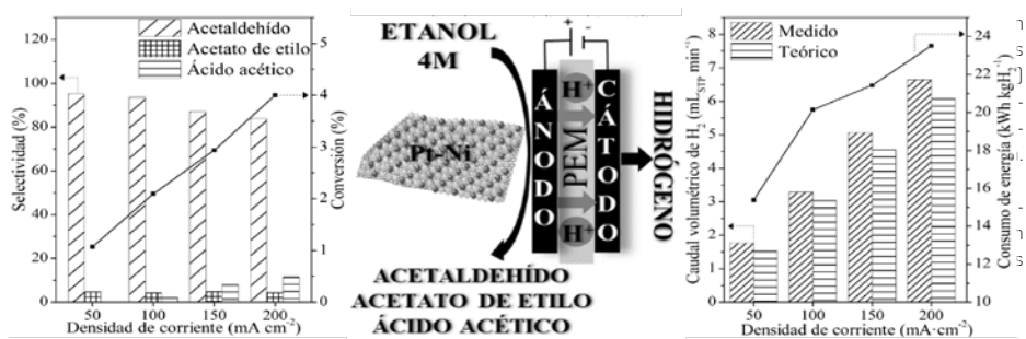
Figura 1. Esquema de reactor de electro-reformado de etanol y análisis de los productos de reacción.
